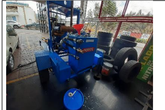
FOTO 30. Motobomba FORTE después del mantenimiento general
