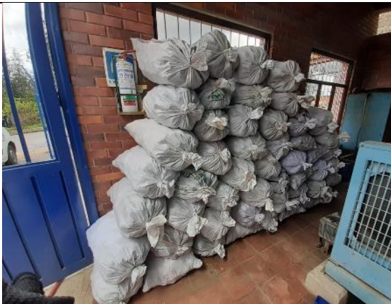
FOTO 7. Suministro de relleno plástico nuevo para las torres de aireación
