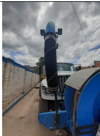
FOTO 37 y 38. Cambio mangueras equipo succionador vaccon
